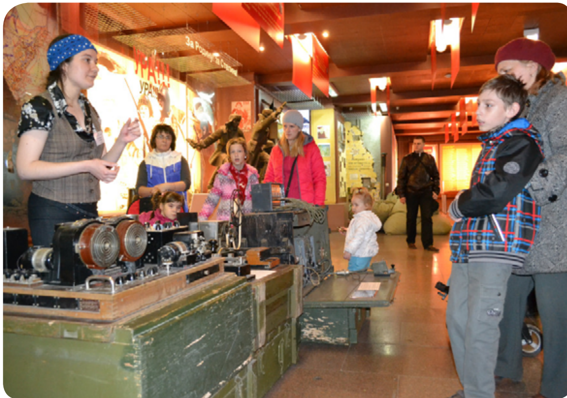
Дивизионная рация, передающая сообщения при помощи кода Бодо
